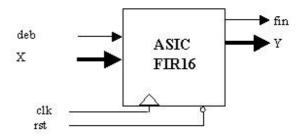
Le signal x(n) arrive par un port parallèle, le résultat y(n) est également transmis en parallèle. Ces données sont codées sur 8 bits. La fréquence d'échantillonnage est fixée à 8kHz, elle correspond à l'arrivée des échantillons x(n). Un signal deb respecte cette fréquence et indique qu'un nouvel échantillon est disponible. Un signal *fin* indique que l'ASIC a terminé son calcul. Le protocole de ces 22 signaux est libre.
