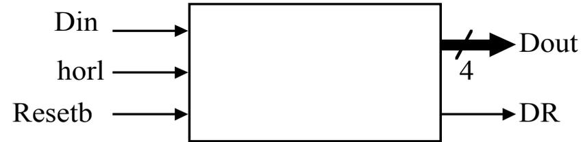
Le message binaire débute par un start bit ( $D_{in}=0$ ) suivi des 4 bits d'information et se termine par 2 stop bits ( $D_{in}=1$ ). Le circuit reconstitue le mot de 4 bits et le présentera après réception sur le bus de sortie Dout en activant le signal DR (Data Ready).
